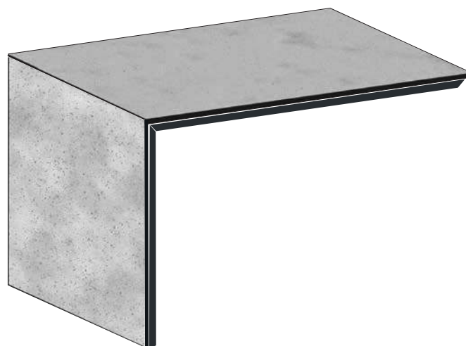
2. Taglio a 45° per montaggio a L*
